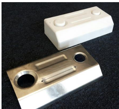
Moule d'elastofmage en polycarbonate imprimé 3D
